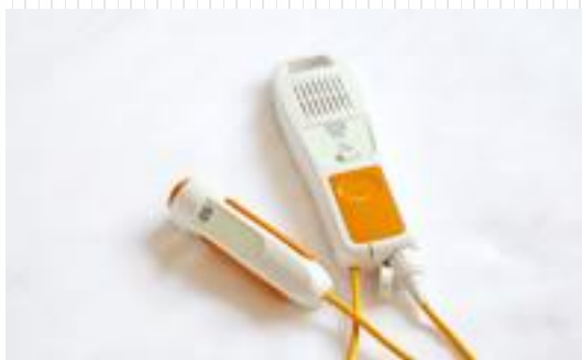
緊急通報装置(室内)
